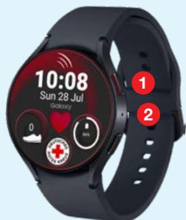
Ein Druck auf die **Notfalltaste 1** baut eine direkte Verbindung zur rund um die Uhr besetzten Hausnotrufzentrale auf. Das Gespräch erfolgt über eine integrierte **Freisprecheinrichtung 2**.
